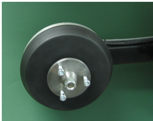
Slika 1. SDG elektromotor v obliki pesta kolesa
